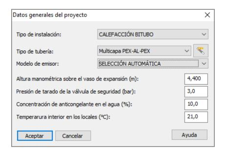
Figura 2b. Datos generales de la instalación.
