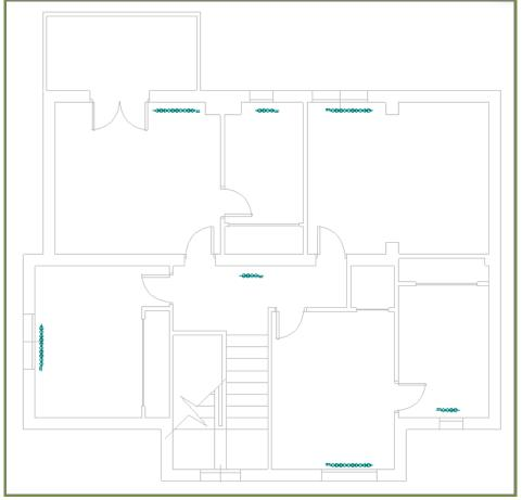
Figura 9. Posición de los paneles radiantes en la planta alta.
