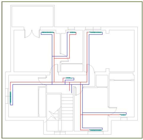
Figura 16. Conexionado entre dispositivos en planta alta.
