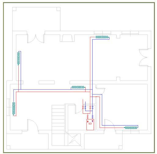
Figura 15. Conexionado entre dispositivos en planta baja.
