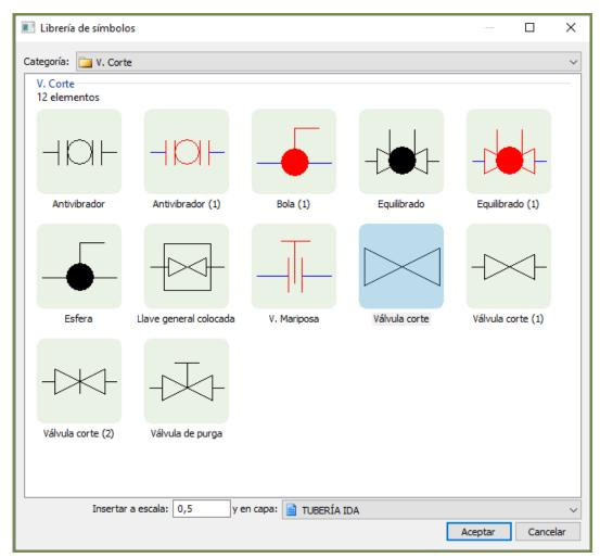
Figura 14. Selección del símbolo para las válvulas de corte.
