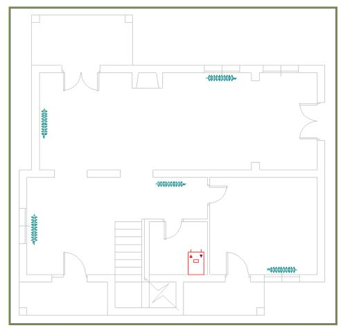
Figura 8. Posición de los símbolos de radiadores bitubo en planta baja.
