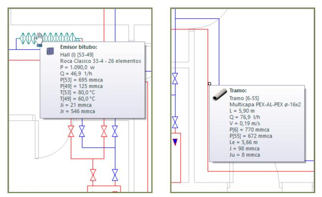
Figura 37. Información por pantalla de un emisor y de un tramo de tubería.
