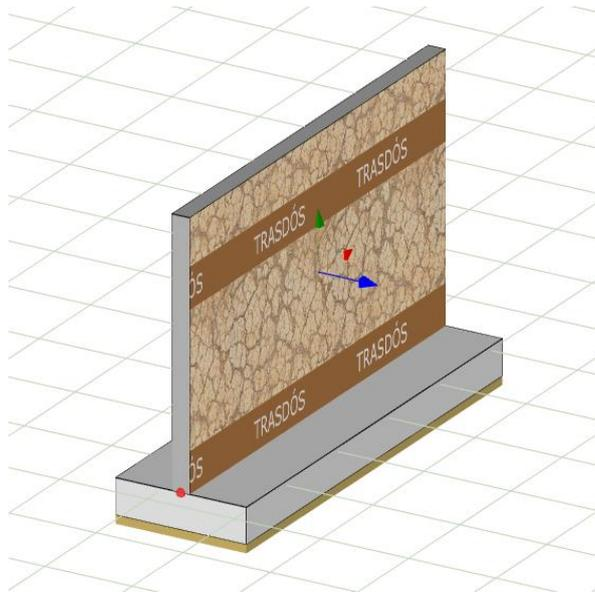
*Trasdós situado en el sentido positivo del eje local perpendicular al muro de hormigón.*
