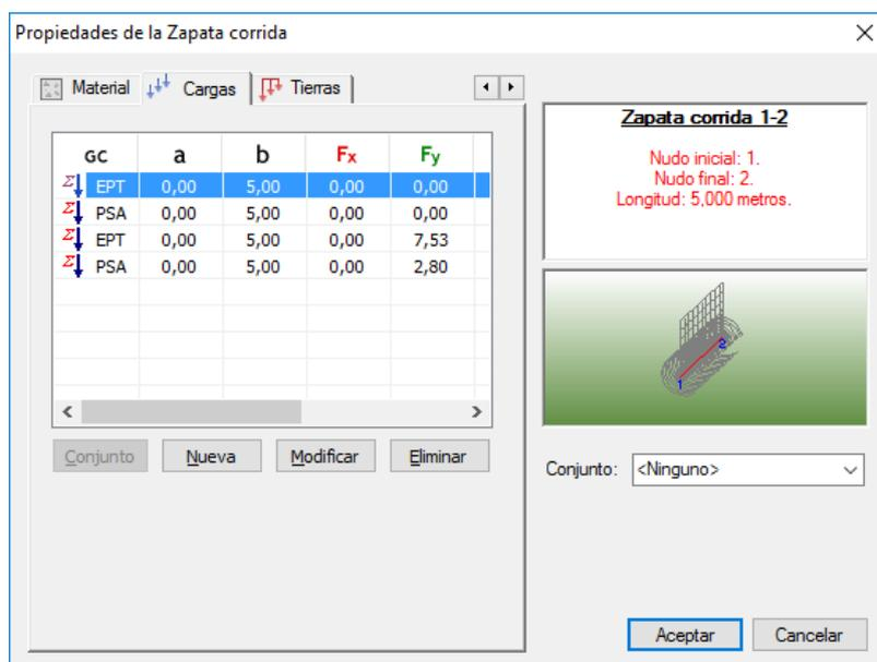
*Cargas automáticas producidas por el terreno del trasdós sobre la zapata corrida.*
