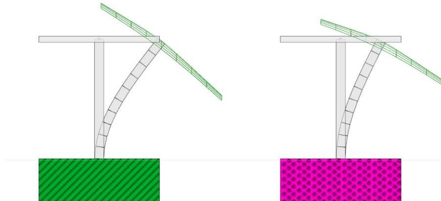
*Deformación diferente bajo carga sísmica de estructuras idénticas situadas sobre terrenos diferentes.*
