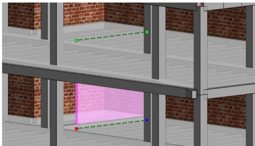
*Error de excepción interna producido por imprecisión geométrica al introducir el muro*
